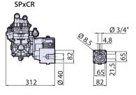
With reduction gear - Con riduttore
